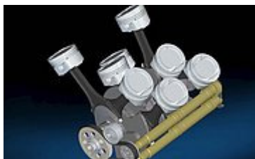
▶ Mit Röntgenblick: Kolben, Pleuel, Kurbelwelle ohne Zylinder.
